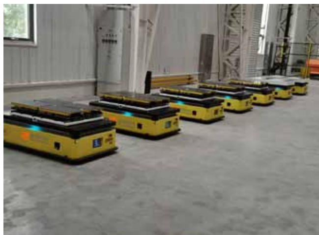
图表 61：迦智科技全向重载 AGV 在输配电及控制设备工厂应用
