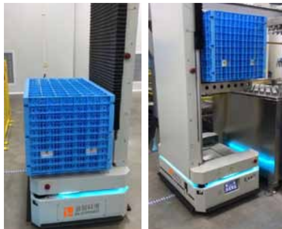
图表 71：迦智科技智能叉取 AGV 食品生产车间应用
