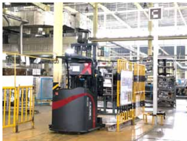
图表 70：未来机器人工业无人车辆在汽车零配件无人仓内应用
