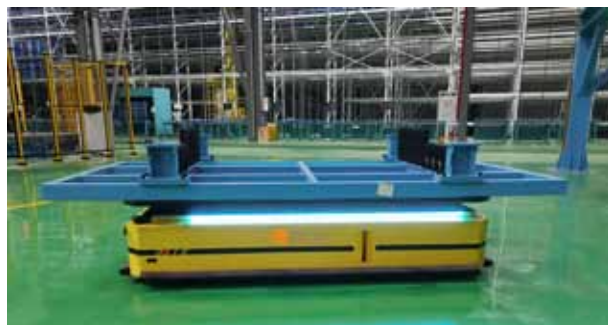
图表 60：迦智科技重载全向 AGV 在配电设备车间应用
