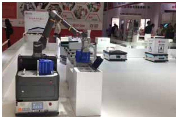
图表 52：迦智科技“移动 AGV+ 机械臂”复合解决方案
