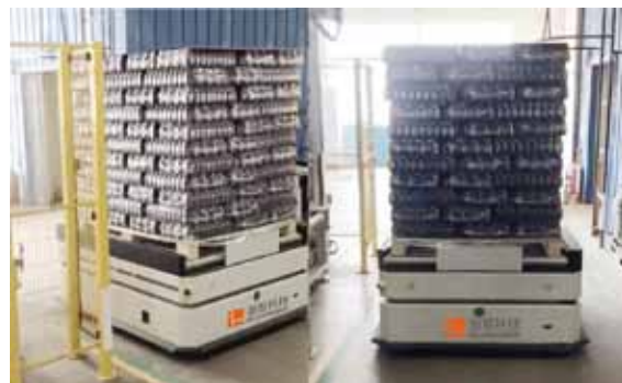
图表 63：迦智科技 1.5T 重载 AGV 在医药包装车间应用
