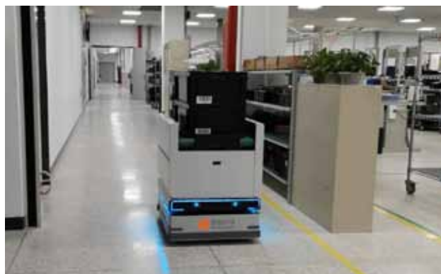
图表 54：迦智科技 AGV 在电子产品生产车间应用
