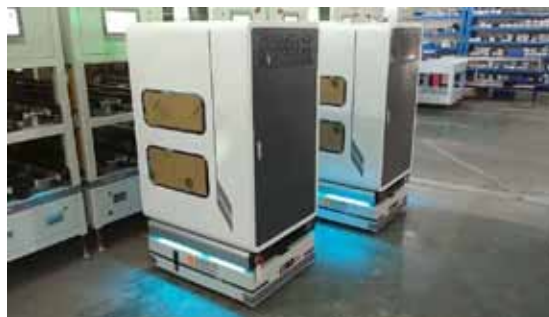
图表 62：迦智科技 AGV 光伏电池片生产车间应用
