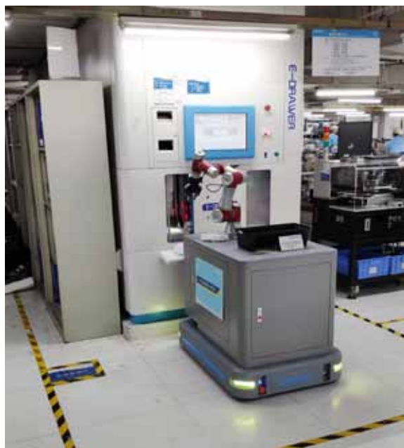
图表 51：节卡协作机器人在 SMT 贴片车间应用
