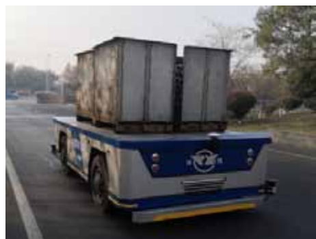
图表 69：蓬翔汽车重载 AGV 在汽配行业室外转运应用
