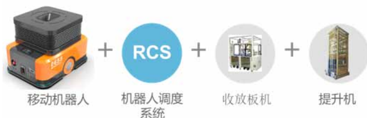
图表 47：移动机器人跨楼层转运要素
