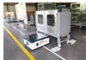
图表 66：迦智科技 AGV 在汽车零部件车间应用
